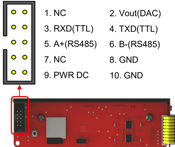
\* 通信协议为modbus RTU, ID可以修改。
